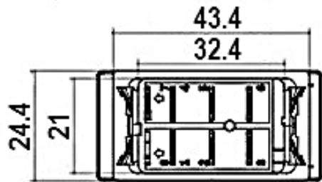
Переключатели тип: (ВКЛ)/ВЫКЛ/(ВКЛ)(без фиксации в положении ВКЛ)
